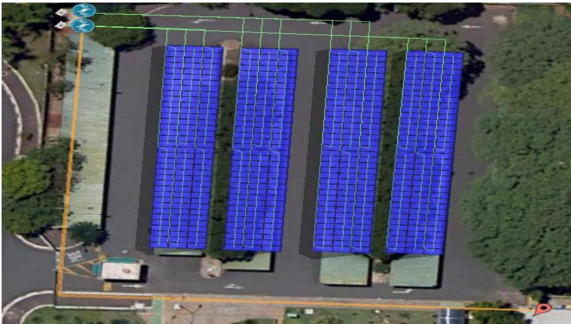
Figura 1-Áreas destinadas à implantação do SFCR com a disposição preliminar dos módulos FV (Fonte: HelioScope 2021, elaboração própria)
